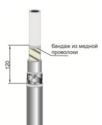
**5.**Медной проволокой на расстоянии 120 мм от среза оболочки кабеля сделать бандаж на ленточном экране. Расплести и удалить экран от бандажа до торца кабеля.
