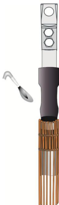
**6.**На жилу кабеля надеть трубку стресс-контроль до упора в проволочный экран. Усадку производить от среза электропроводящего экрана в две стороны. Для расплавления жёлтой ленты стресс-контроль необходимо тщательно прогревать место намотки беглым пламенем газовой горелки.
