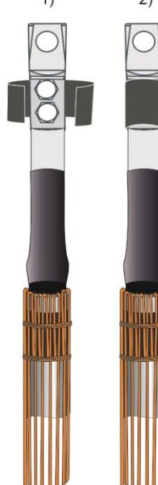
**8.**На участок кабеля поверх трубы стресс-контроль и до наконечника равномерно, по всей окружности, нанести тонкий слой пасты КПД.
