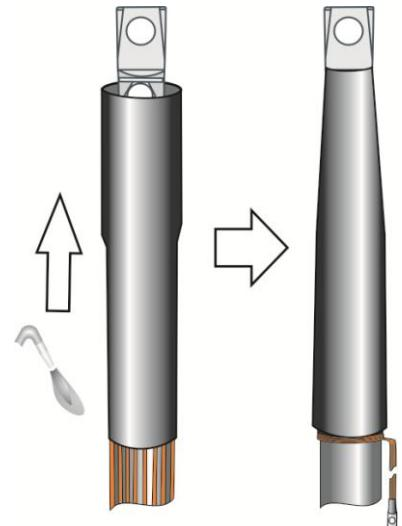
**Не подвергать механическому воздействию до полного остывания!**
