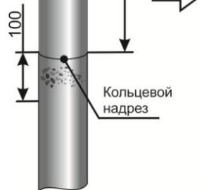
3. С помощью специального инструмента (роликового ножа) снять электропроводящий слой с жил кабеля, оставив участок длиной 40мм у места загиба проволок экрана кабеля.
