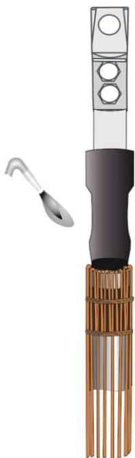
**6.**На жилу кабеля надеть трубку стресс-контроль до упора в проволочный экран. Усадку производить от среза электропроводящего экрана в две стороны. Для расплавления жёлтой ленты стресс-контроль необходимо тщательно прогреть место намотки беглым пламенем газовой горелки.
