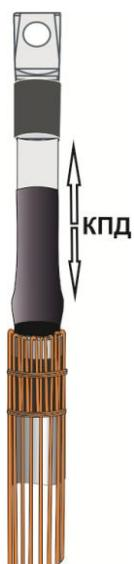
**8.**На участок кабеля поверх трубки стресс-контроль и до наконечника равномерно, по всей окружности, нанести тонкий слой пасты КПД.
