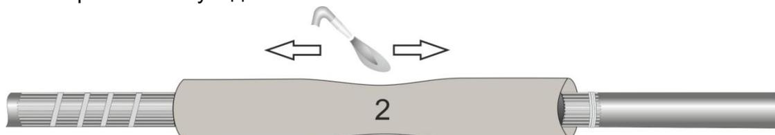
**12.** Надеть на место соединения жил трубку №3, разместить по центру и усадить. Усадку производить от центра, не допуская перегрева трубки, образования копоти и сажи. Обезжирить после усадки.
