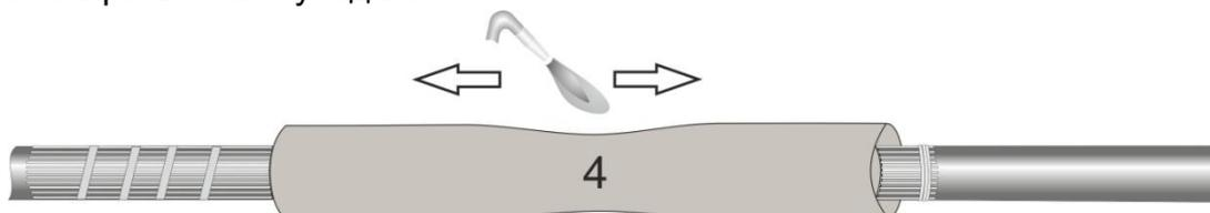
**14.** Надеть на место соединения жил трубку №5 (двухслойную), разместить по центру и усадить. Усадку производить от центра, не допуская перегрева трубки, образования копоти и сажи. Обезжирить после усадки.
