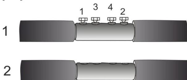
**10.** Обернуть соединительную гильзу пластиной для выравнивания напряжённости электрического поля для гильз, ориентируя пластину в соответствии с рисунком. Пластина должна полностью закрывать гильзу и заходить на жилы кабеля не более чем на 5 мм, перехлёст пластины должен закрывать место срыва болтов.
