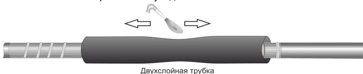
**15.** На усаженную двухслойную трубку надвинуть экран из сетки рукавной, расправить экран по трубке так, чтобы он плотно облегал экранирующий слой трубки.
