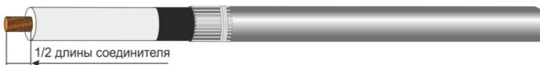
**6.** Обезжирить поверхность жилы и срез электропроводящего слоя в направлении от торца кабеля к срезу оболочки. Отступив 40мм от загиба проволоки произвести намотку жёлтой ленты-мастики, вытягивая её так, чтобы ширина ленты уменьшилась в два раза. Намотку производить с перехлёстом между витками 50%. Лента должна заходить на изоляцию на 10мм от среза электропроводящего слоя и возвращаться назад к началу намотки.
