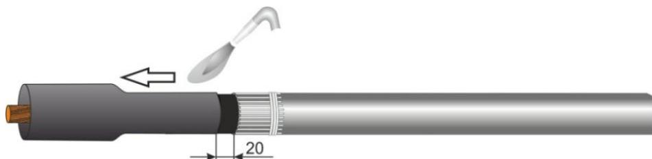
**8.** **Внимание!** Для предотвращения загрязнения внутренней поверхности защитных кожухов необходимо на внешний покров соединяемых кабелей предварительно надеть и зафиксировать плёнку рукавную.
