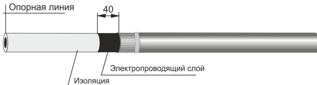
**5.** С конца каждой жилы снять фазную изоляцию на длине, равной половине длины соединительной гильзы.
