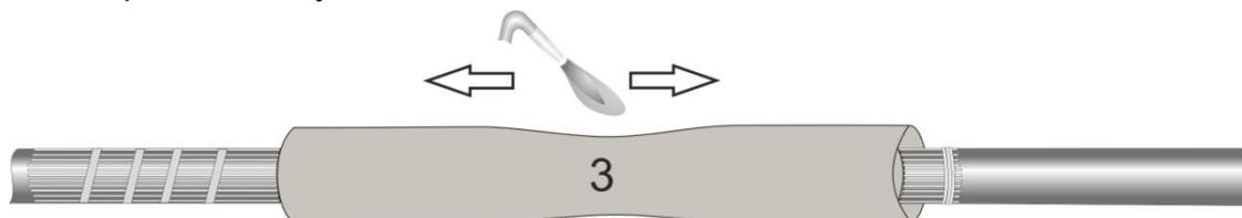
**13.** Надеть на место соединения жил трубку №4, разместить по центру и усадить. Усадку производить от центра, не допуская перегрева трубки, образования копоти и сажи. Обезжирить после усадки.
