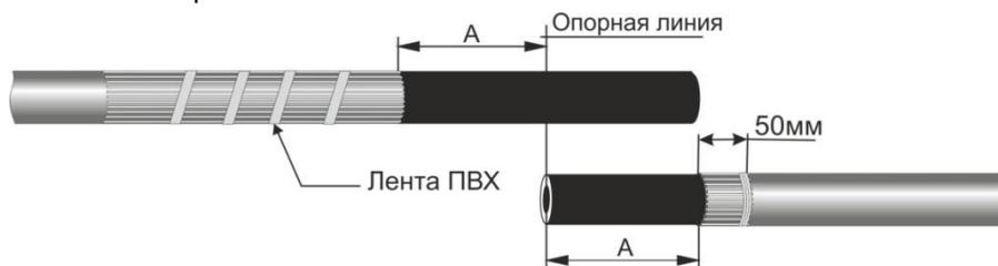
**4.** С помощью специального инструмента (роликового ножа) снять электропроводящий экран с жилы кабеля, оставив участок экрана длиной 40 мм у среза оболочки кабеля. При снятии электропроводящего слоя использовать упорную шайбу. Срез экрана должен быть ровным, без задиров, заусенцев и надрезов. Поверхность полиэтиленовой изоляции обезжирить салфеткой с растворителем в направлении от торца кабеля к срезу оболочки.
