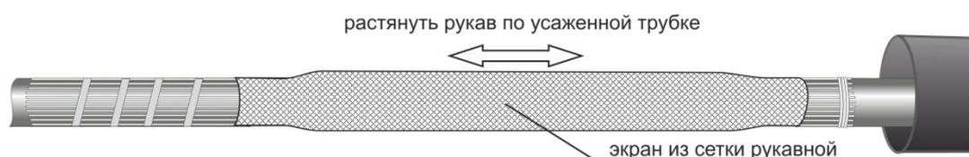
**16.** Снять временно наложенную ленту ПВХ, закрепляющую проволоки экрана большей длины. Отогнуть проволоки экрана так, чтобы они заходили на проволоки экрана меньшей длины. Разложить их параллельно друг другу. Закрепить оба экрана бандажами из медной проволоки в соответствии с рисунком. На место соединения экранов намотать ППД. Выступающие проволоки экрана удалить.
