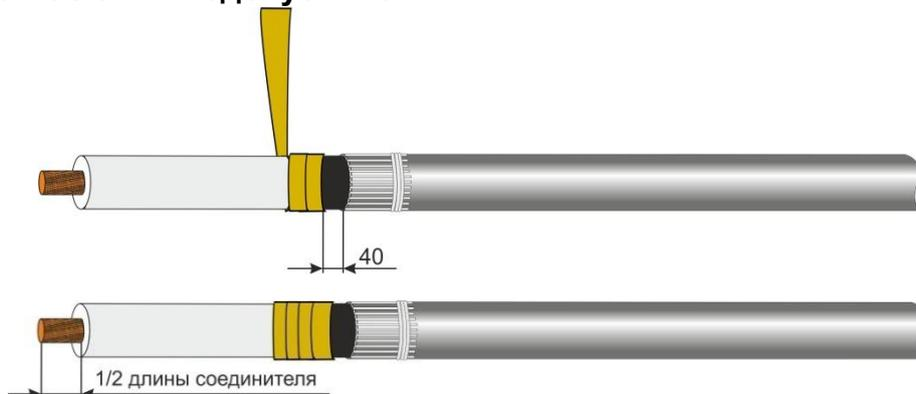
**7.** Надвинуть трубку стресс-контроля №1(ТТР) на жилу кабеля в соответствии с рисунком и усадить. Усадку производить от среза оболочки к торцу жилы. Удалить торцы трубок, выходящие за пределы изоляции.
