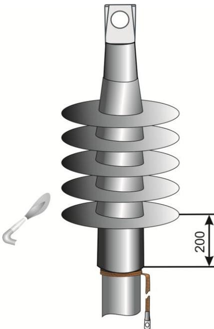
**10.** Усадить поверх трекингостойкой трубки изоляторы в соответствии с рисунком.
