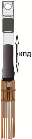
**9.** Надвинуть на кабель трекингостойкую трубку, выровняв ее по наконечнику таким образом, чтобы свободной оставалась только контактная часть наконечника. Усадку производить по направлению к наконечнику. Очистить контактную часть наконечника от остатков клея.
