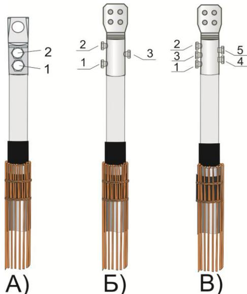
4. Снять полиэтиленовую изоляцию с жилы кабеля на расстоянии, равном внутренней длине цилиндрической части наконечника. Надвинуть наконечник и сорвать головки болтов согласно рисунку.
