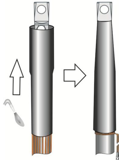
**9.**Надвинуть на кабель трекингостойкую трубку, выровняв ее по наконечнику таким образом, чтобы свободной оставалась только контактная часть наконечника. Усадку производить по направлению к наконечнику. Очистить контактную часть наконечника от остатков клея.
