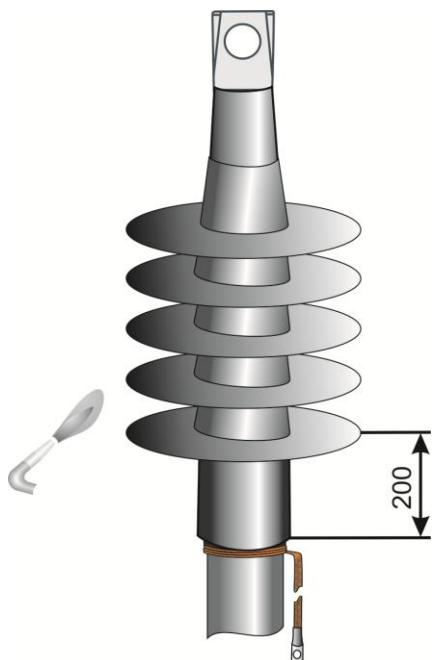
**10.**Усадить поверх трекингостойкой трубы изоляторы в соответствии с рисунком.
