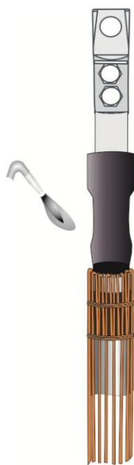
**6.** На жилу кабеля надеть трубку стресс-контроль до упора в проволочный экран. Усадку производить от среза электропроводящего экрана в две стороны.
