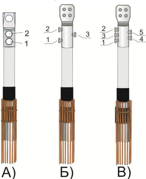
4. Снять полиэтиленовую изоляцию с жилы кабеля на расстоянии, равном внутренней длине цилиндрической части наконечника. Надвинуть наконечник и сорвать головки болтов согласно рисунку.
