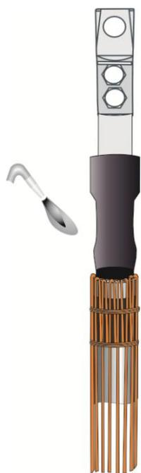
6. На жилу кабеля надеть трубку стресс-контроль до упора в проволочный экран. Усадку производить от среза электропроводящего.
