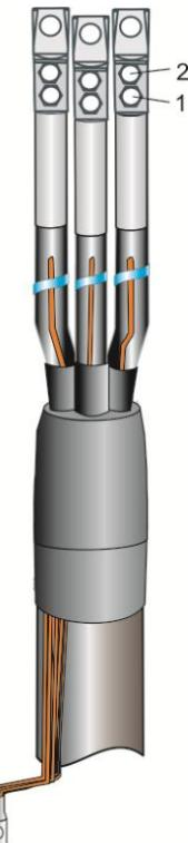
8. Снять фазную изоляцию с жил кабеля на расстоянии, равном внутренней длине цилиндрической части наконечника. Надвинуть наконечники и сорвать головки болтов в соответствии с рисунком.
