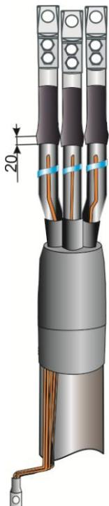
11. На жилы кабеля надеть трубки стресс-контроль так, чтобы они на 20мм заходили за жёлтую ленту. Усадку производить от среза электропроводящего экрана. Для расплавления жёлтой ленты стресс-контроль необходимо тщательно прогревать место ее намотки беглым пламенем газовой горелки.
