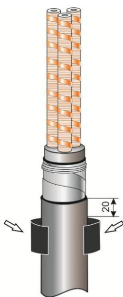
4. На оболочку кабеля нанести ленту-герметик для герметизации узла заземления, выдержав расстояние, указанное на рисунке.
