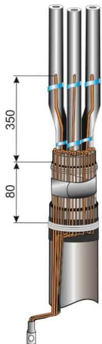
6. Заизолировать узел заземления лентой ПВХ (во избежание попадания клея под ППД и, как следствие, ухудшения контакта). Надвинуть на узел заземления бандажирующую манжету и усадить её пламенем горелки. Манжета должна выходить за срез брони в сторону жил на 25мм.
