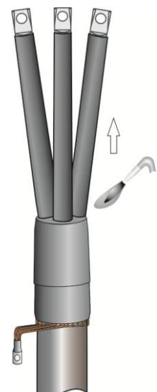
14. На жилы кабеля надвинуть трекингостойкие трубы на «палцы» перчатки до упора. Усадить трубы, начиная с «пальцев» перчатки. Обрезать трубы так, чтобы свободной оставалась только контактная часть наконечников.
