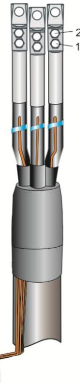
9. Снять фазную изоляцию с жил кабеля на расстоянии, равном внутренней длине цилиндрической части наконечника. Надвинуть наконечники и сорвать головки болтов в соответствии с рисунком.
