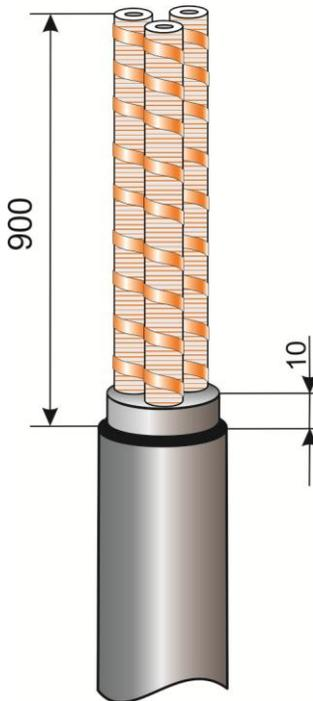
3. На оболочку кабеля нанести ленту-герметик для герметизации узла заземления, выдержав расстояние, указанное на рисунке.
