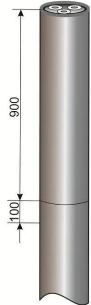
2. Удалить оболочку кабеля с торца до кольцевого надреза. Для облегчения снятия оболочки ее необходимо подогреть пламенем горелки до температуры 50...70°C.
