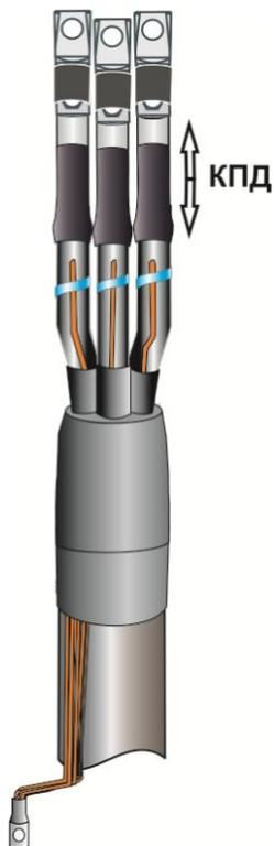
**13.** На жилы кабеля надвинуть трекингостойкие трубки на «пальцы» перчатки до упора. Усадить трубки, начиная с «пальцев» перчатки. Обрезать трубки так, чтобы свободной оставалась только контактная часть наконечников.
