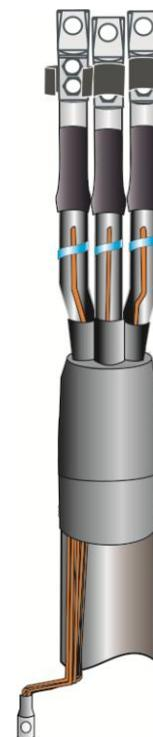
**12.** На каждую жилу кабеля поверх трубки стресс-контроль и до наконечника равномерно, по всей окружности, нанести тонкий слой пасты КПД.
