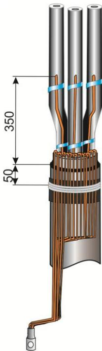
4. Удалить ленты, бандажирующие экран кабеля. Расплести проволоки и отогнуть их на оболочку кабеля, предварительно оставив по одной проволоке экрана длиной 350мм на каждой жиле. На жилах кабеля проволоки зафиксировать лентой ПВХ из комплекта муфты. Отогнутые проволоки уложить по оболочке кабеля, вдавив их в герметик. На оболочке кабеля проволоки зафиксировать бандажом из 3-4 витков проволоки. Проволоки медного экрана скрутить в жилу и оконцевать наконечником.
