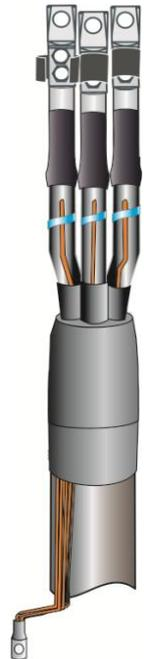
13. На каждую жилу кабеля поверх трубки стресс-контроль и до наконечника равномерно, по всей окружности, нанести тонкий слой пасты КПД.
