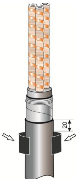
4. На оболочку кабеля нанести ленту-герметик для герметизации узла заземления, выдержав расстояние, указанное на рисунке.
