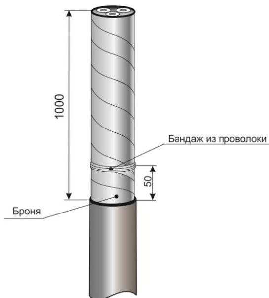
2. Удалить оболочку кабеля с торца до кольцевого надреза. Для облегчения снятия оболочки ее необходимо подогреть пламенем горелки до температуры 50...70°C.
