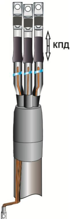
14. На жилы кабеля надвинуть трекинговые трубки на «пальцы» перчатки до упора. Усадить трубки, начиная с «пальцев» перчатки. Обрезать трубки так, чтобы свободной оставалась только контактная часть наконечников.
