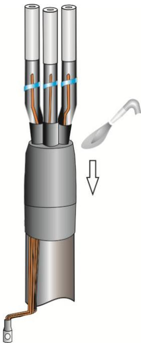
7. Сблизить жилы и надеть термоусаживаемую перчатку так, чтобы каждая жила попала в отверстие соответствующего «пальца». Продвинуть перчатку как можно ближе к «корешку» разделки кабеля. Усадить перчатку сначала с «пальцев» перчатки на жилы, затем - на оболочку кабеля сверху вниз. После усадки перчатка должна плотно облегать манжету и изоляцию на жилах кабеля. По периметру «юбки» и «пальцев» перчатки должен быть заметен выступивший расплавленный клей.
