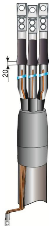
10. На жилы кабеля надеть трубки стресс-контроль так, чтобы они на 20мм заходили за жёлтую ленту. Усадку производить от среза электропроводящего экрана. Для расплавления жёлтой ленты стресс-контроль необходимо тщательно прогревать место ее намотки беглым пламенем газовой горелки.
