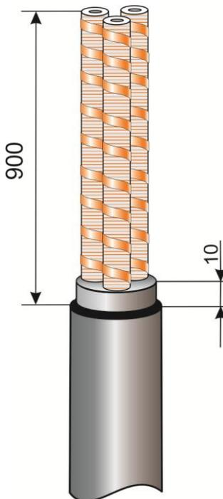
2. Удалить оболочку кабеля с торца до кольцевого надреза. Для облегчения снятия оболочки ее необходимо подогреть пламенем горелки до температуры 50...70°C.
