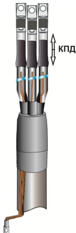
12. На каждую жилу кабеля поверх трубки стресс-контроль и до наконечника равномерно, по всей окружности, нанести тонкий слой пасты КПД.
