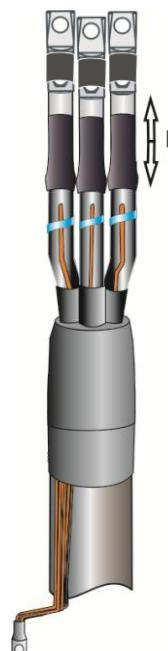
12. На каждую жилу кабеля поверх трубы стресс-контроль и до наконечника равномерно, по всей окружности, нанести тонкий слой пасты КПД.
