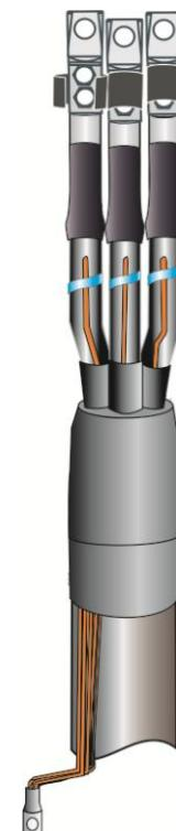
13. На жилы кабеля надвинуть трекингостойкие трубы на «пальцы» перчатки до упора. Усадить трубы, начиная с «пальцев» перчатки. Обрезать трубы так, чтобы свободной оставалась только контактная часть наконечников.
