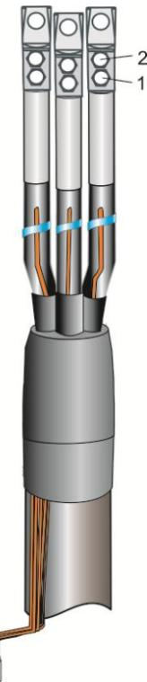
8. Снять фазную изоляцию с жил кабеля на расстоянии, равном внутренней длине цилиндрической части наконечника. Надвинуть наконечники и сорвать головки болтов в соответствии с рисунком.
