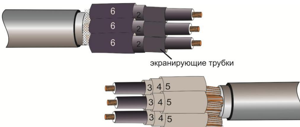
**9.** Ввести зачищенные концы жил в соединитель и затянуть винты до срыва головок. Срыв головок винтов производить в последовательности, указанной на рисунке. Выступающие части, оставшиеся после срыва головок, необходимо удалить напильником, предварительно защитив жилы кабеля от попадания стружки. Удалить металлическую стружку с соединительной гильзы, обезжирить гильзу.
