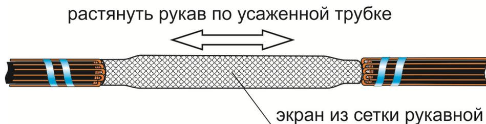
**24.** Снять временно наложенную ленту ПВХ, закрепляющую проволоки экрана большей длины. Отогнуть проволоки экрана так, чтобы они заходили на проволоки экрана меньшей длины. Разложить их параллельно друг другу. Закрепить оба экрана бандажами из медной проволоки в соответствии с рисунком. На место соединения экранов намотать ППД. Выступающие проволоки экрана удалить.
