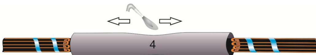
**19.** После остывания усаженной трубки с помощью салфетки и уайт-спирита обезжирить её поверхность. Смазать тонким слоем пасты КПД по всей окружности.
