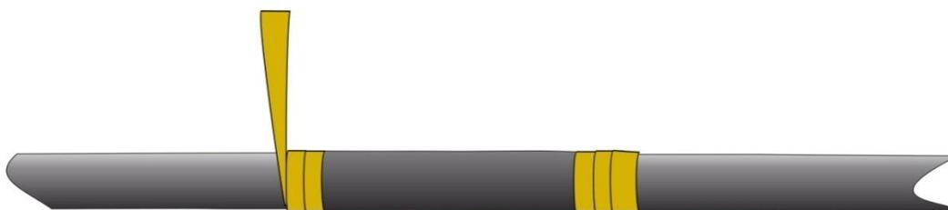
**13.** Тонким слоем по всей окружности экранирующей трубки и жильных трубок стресс-контроль, не заходя на жёлтую ленту, нанести пасту КПД.
