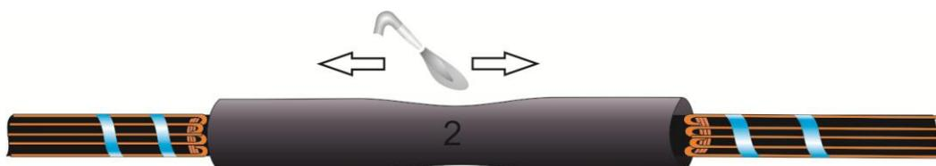
**15.** После остывания усаженной трубки с помощью салфетки и уайт-спирита обезжирить её поверхность. Смазать тонким слоем пасты КПД по всей окружности.
