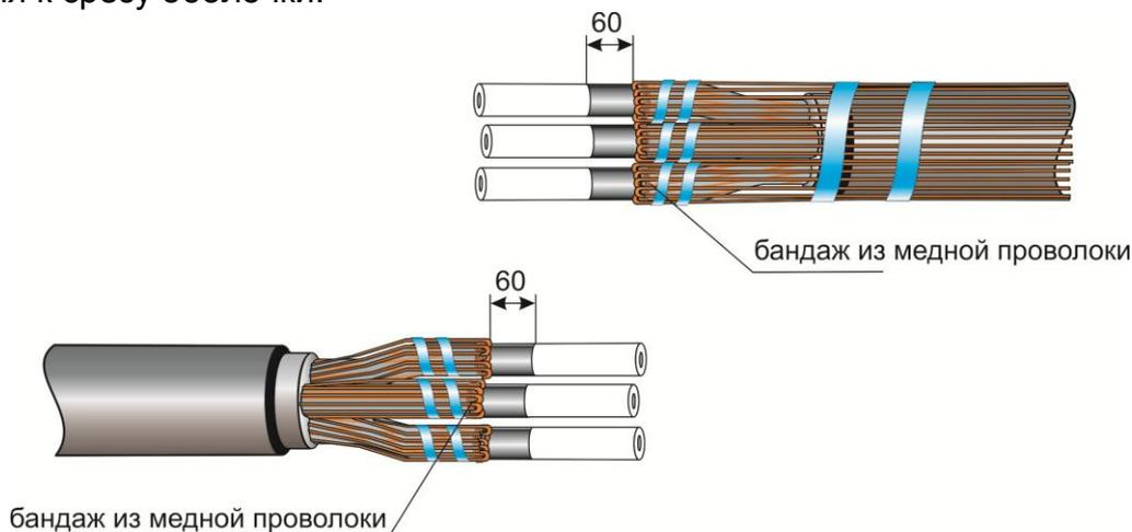
**5.** С конца каждой жилы снять фазную изоляцию на длине, равной половине длины соединительной гильзы.
