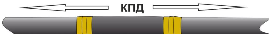
**14.** Надеть на место соединения жил трубку стресс-контроля №2, разместить по центру и усадить. Усадку производить мягким пламенем горелки, начиная от центра, не допуская перегрева, образования копоти и сажи.
