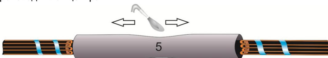
**21.** После остывания усаженной трубки с помощью салфетки и уайт-спирита обезжирить её поверхность. Смазать тонким слоем пасты КПД по всей окружности.
