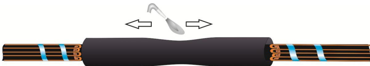
**23.** На усаженную двухслойную трубку надвинуть экран из сетки рукавной, расправить экран по трубке так, чтобы он плотно облегал экранирующий слой трубки.
