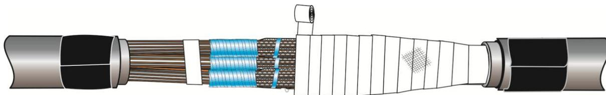
**29.** Надвинуть на муфту одну из трубок защитного кожуха так, чтобы торец трубки выходил на расстояние не менее 150мм за срез оболочки кабеля. Усадить трубку. В предполагаемом месте перехлеста труб нанести герметик. Надвинуть вторую трубку аналогично первой. Перехлест между трубками должен составлять 150-200мм. Усадить вторую трубку внешнего защитного кожуха.
