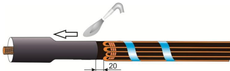
**8.** **Внимание!** Для предотвращения загрязнения внутренней поверхности защитных кожухов необходимо на оболочку соединяемых кабелей предварительно надеть и зафиксировать плёнку рукавную.
