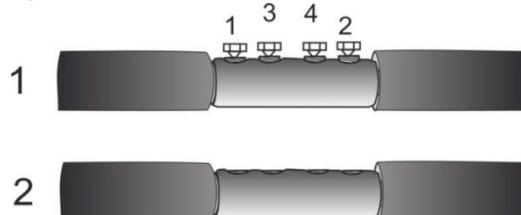
**10.** С небольшим натягом и перехлёстом между витками в 30% произвести намотку проводящей ленты, равномерно распределяя её по гильзе. Диаметр по ленте должен максимально соответствовать диаметру кабеля по жиле. Лишнюю ленту обрезать. **Намотка должна производиться чистыми руками. Образование складок и пустот недопустимо.**
