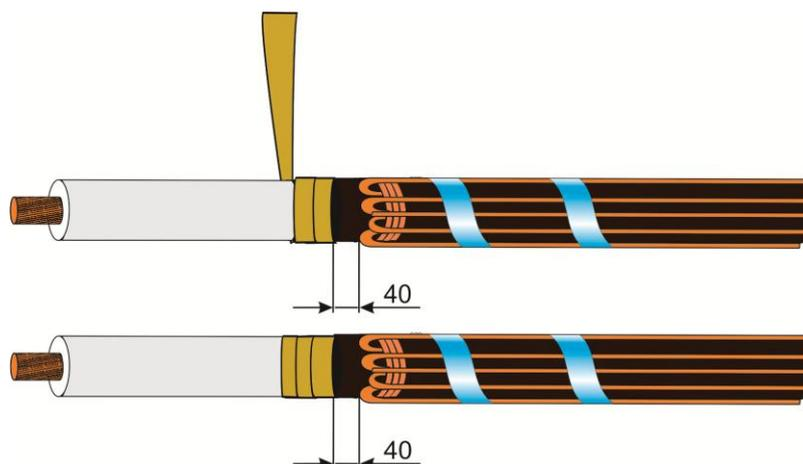
**7.** Надвинуть трубку стресс-контроля №1 на жилу кабеля в соответствии с рисунком и усадить. Усадку производить от проволок экрана к торцу жилы. После остывания удалить торцы трубок, выходящие за пределы изоляции.
