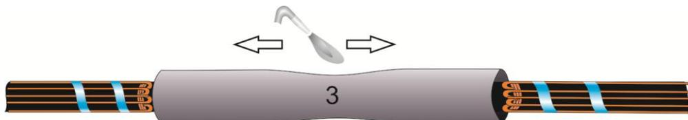
**17.** После остывания усаженной трубки с помощью салфетки и уайт-спирита обезжирить её поверхность. Смазать тонким слоем пасты КПД по всей окружности.
