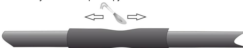
**12.** На края экранирующей трубки после усадки произвести намотку жёлтой ленты-мастики, вытягивая её так, чтобы ширина ленты уменьшилась в два раза. Намотку производить с перехлёстом между витками 50%.
