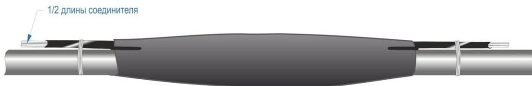
**2.** Предварительно надев на транспозиционные кабели манжеты для изолирования контактного соединения, ввести зачищенные концы экранов и транспозиционного кабеля в соединительную гильзу. Произвести срыв болтов по порядку, указанном на рисунке.
