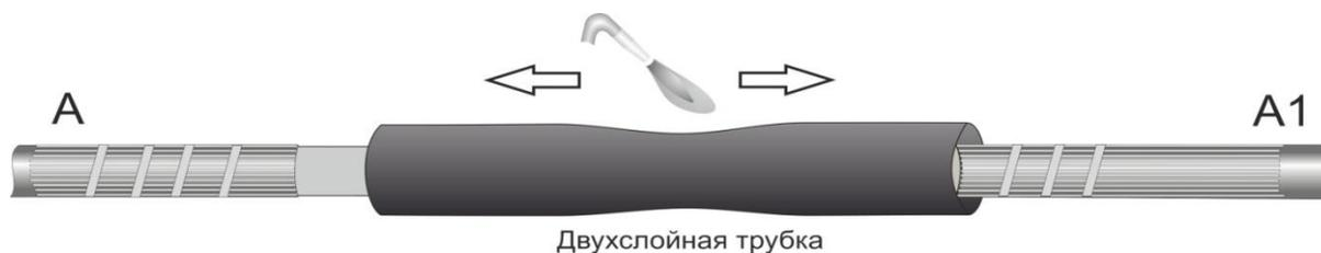
**13.** На расстоянии 100 мм от среза оболочки кабеля очистить проволочный экран от загрязнения, обезжирить. На усаженную двухслойную трубку произвести намотку экрана из медной сетки. **Начало намотки должно заходить на проволочный экран на 50 мм со стороны "А1", окончание намотки не должно доходить до края двухслойной трубки со стороны кабеля "А" на 50 мм.** Намотку следует производить с перехлестом в 30%.
