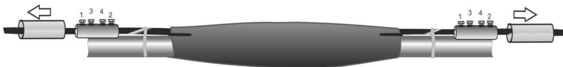
**3.** Надвинуть изолирующие манжеты на место контактного соединения, усадить пламенем газовой горелки.
