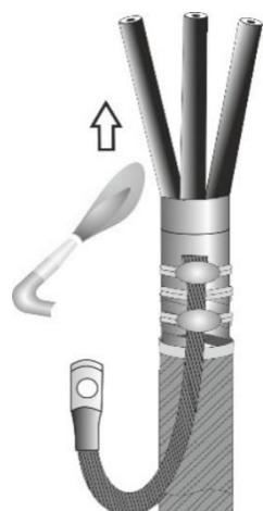
6. Для муфты 6-10 кВ обернуть герметиком срез оболочки кабеля с заходом 20 мм на поясную изоляцию, обернуть герметиком место пайки проводника заземления.
