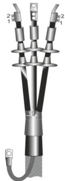
**15.** Надвинуть термоусаживаемые изолирующие манжеты на трубчатую часть наконечников и усадить, начиная с середины. После усадки манжеты должны плотно облегать наконечники и трубы на жилах кабеля. По торцам манжет должен выступить расплавленный клей.
