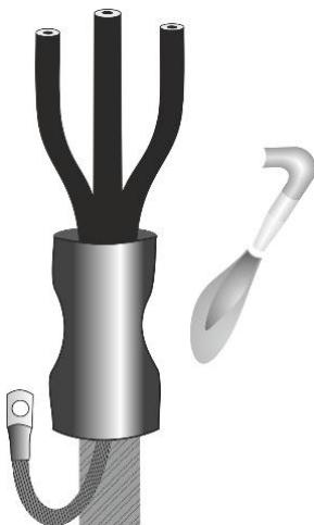
7. На оболочку кабеля и места пайки провода заземления, до жил кабеля (с заходом на поясную изоляцию), надвинуть термоусаживаемую бандажирующую манжету ТУТ для герметизации узла заземления и усадить её, как показано на рисунке, начиная от середины. После усадки по торцам манжеты должен быть виден выступивший расплавленный клей. Манжета должна облегать оболочку кабеля, не иметь морщин и складок.
