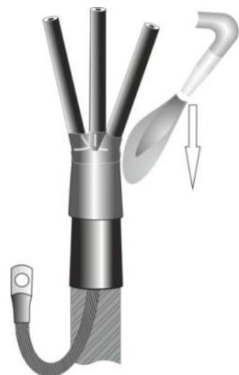
На жилы кабеля надвинуть распорные изоляторы. Усадить прогревая цилиндрические части изолятора.
