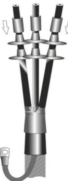
**12.** Определить длину жил по месту присоединения и обрезать. На жилы кабеля надвинуть термоусаживаемые изолирующие манжеты для изоляции наконечников и сдвинуть их в сторону корешка разделки.
