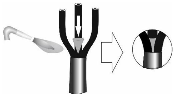
9. На жилы кабеля надеть термоусаживаемую изолирующую перчатку так, чтобы каждая жила попала в отверстие соответствующего “пальца”. Продвинуть перчатку как можно ближе к корешку разделки кабеля. Усадку перчатки следует производить в направлении от пальцев к юбке. После усадки перчатка должна плотно облегать манжету и изоляцию на жилах кабеля. По периметру “юбки” и “пальцев” перчатки должен быть замечен выступивший расплавленный клей.
