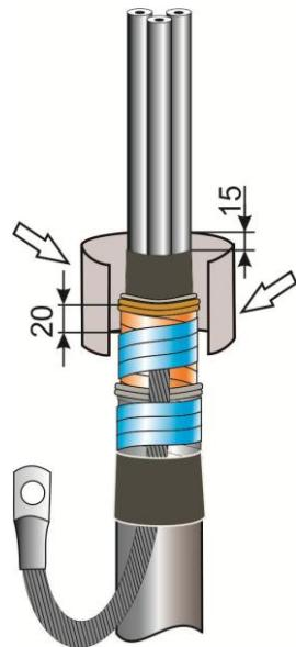
**7.Установить манжету бандажирующую таким образом, чтобы она отстояла вверх на 10 мм от нижнего края пластины выравнивания.**
