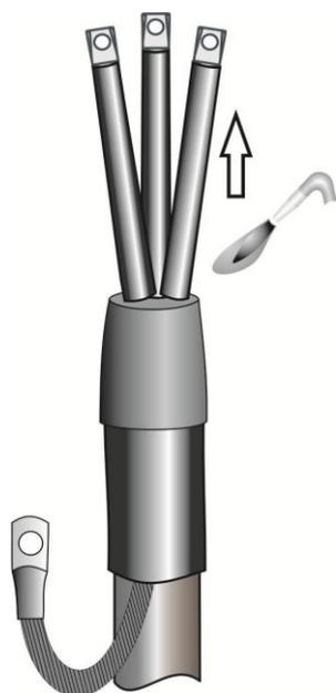
**12.** На жилы кабеля надвинуть трекингостойкие термоусаживаемые трубки ТУТ для изолирования жил кабеля так, чтобы они заходили клеевым подслоем на “пальцы” перчатки до упора. Усадить трубки, начиная с “пальцев” перчатки.
