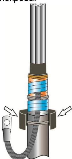
5. Обмотать лентой-герметиком бандаж из оцинкованной проволоки в соответствии с рисунком.
