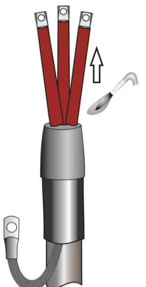
**12.** На жилы кабеля надвинуть трекингостойкие термоусаживаемые трубы ТУТ для изолирования жил кабеля так, чтобы они заходили kleевым подслоем на "пальцы" перчатки до упора. Усадить трубы, начиная с "пальцев" перчатки.
