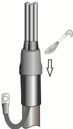
**10.** Сблизить жилы и надеть термоусаживаемую изолирующую перчатку так, чтобы каждая жила попала в отверстие соответствующего "пальца". Продвинуть перчатку как можно ближе к корешку разделки кабеля. Усадить перчатку сначала с "пальцев" перчатки на жилы, затем - на наружный покров кабеля сверху вниз. После усадки перчатка должна плотно облегать бандажирующую манжету и изоляцию на жилах кабеля. По периметру "юбки" и "пальцев" перчатки должен быть замечен выступивший расплавленный клей.
