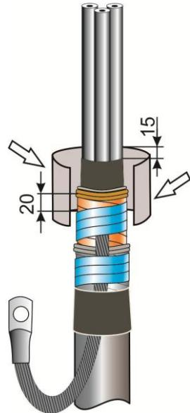
**7.Установить манжету бандажирующую таким образом, чтобы она отстояла вверх на 10 мм от нижнего края пластины выравнивания.**
