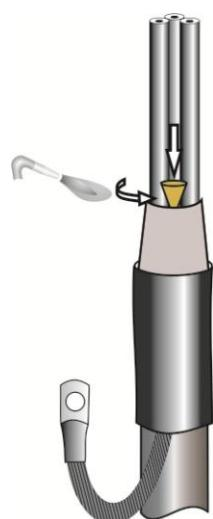
**8.Предварительно прогрев корешок разделки, вставить в корешковую часть разделки конус-регулятор маслостойкий. Затем, подогревая средним пламенем горелки корешковую часть разделки по окружности и основание конуса, необходимо максимально вдавить при помощи инструмента (например, рукояткой отвертки) конус-заполнитель так, чтобы материал выступал между жил и заполнил промежутки между ними.**
