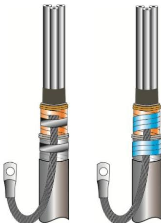
2. Закрепить провод заземления на медном экране кабеля и броне с помощью пружин.
