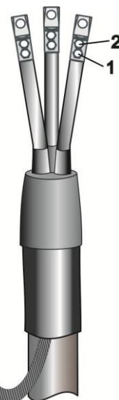
**11.** Снять фазную изоляцию с жил кабеля на расстоянии, равном внутренней длине цилиндрической части наконечника. Надвинуть наконечники и сорвать головки болтов согласно рисунка. Допускается оконцевание жил кабеля наконечниками под опрессовку, пайку (соответствующие наконечники в комплект поставки не входят).
