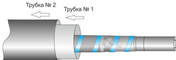
1.5.Снять оболочку кабеля от конца кабеля до второго кольцевого надреза. Удалить электропроводящую бумагу, поясную изоляцию и кордели. Жилы кабеля аккуратно развести, не загрязняя поверхность. Закрепить изоляцию на концах жил 1-2 витками ленты ПВХ. Если поверхность жил чистая, расцветочные ленты с изоляции не снимать.
