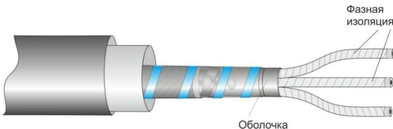
**1.6.** Надеть на жилы кабелей термоусаживаемые трубки №3 для изоляции жил так, чтобы торец трубки доходил до ступени поясной изоляции кабеля, и усадить, начиная от корешка разделки, равномерным прогревом пламени газовой горелки. Пламя горелки должно быть размытым, желтоватого цвета. После усадки трубки должны плотно облепать жилы кабеля, не иметь морщин и складок.
