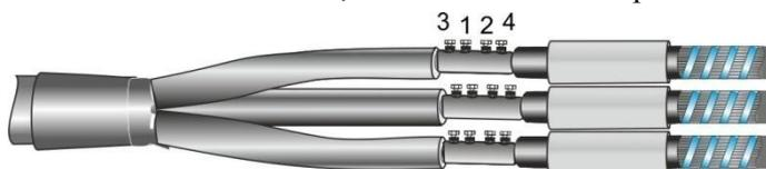
**3.4.** Обернуть соединительные гильзы пластинами выравнивания напряженности электрического поля ( $A=110\text{мм}$  для кабеля с сечением жил  $70-120\text{мм}^2$ ;  $B=130\text{мм}$  для кабеля с сечением жил  $150-240\text{мм}^2$ ). Перехлест ориентировать на месте среза болтов, плотно прижав по всей плоскости. Торцы заправить в зазор. Остатки воздуха не допустимы.
