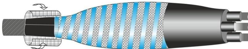
**3.13.**Надвинуть наружную трубку №2 для герметизации муфты на перчатку до пальцев. Удалить пленку рукавную. Усадить наружную трубу. По краям трубки должен выступить клей.
