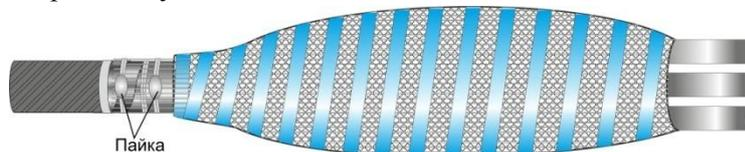
**3.11.** Обернуть место срезов оболочек одножильных кабелей и торца внутренней трубки двумя лентами заполнителя (для герметизации узла заземления), надвинуть перчатку и усадить от пальцев к раструбу.
