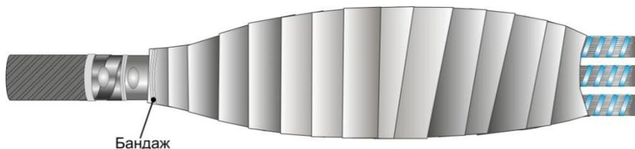
**3.10.** Освободить проволочные экраны одножильных кабелей от бандажей. Проволоки выпрямить и разложить вдоль муфты параллельно друг другу с заходом на броню трехжильного кабеля по всему периметру. Закрепить лентой ПВХ и проволочными бандажами на оболочке и броне и опаять. Выступающие концы проволок удалить.
