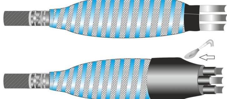
**3.12.**Обернуть срез оболочки и брони лентой для герметизации узла заземления, затем обернуть сеткой для бандажа узла заземления.
