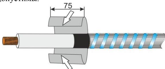
**2.4.** Надвинуть на каждую из жил по одной трубке для экранирования пластмассового кабеля до упора в сгиб проволочного экрана и усадить к торцу жил. Затем надвинуть на каждую жилу трубки для изолирования жил пластмассового кабеля и так же усадить, начиная от сгиба экрана. Остатки воздуха не допустимы.
