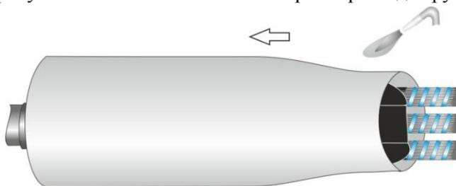
**3.9.** Обмотать поверхность трубы лентой алюминиевой так, чтобы края ленты заходили на металлическую оболочку кабеля с бумажной изоляцией на 10 мм, и закрепить ленту алюминиевую на оболочке кабеля с бумажной изоляцией бандажом из 4-5 витков стальной оцинкованной проволоки. Удалить края ленты, выступающие за бандаж.
