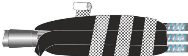
**3.8.** Сдвинуть внутреннюю трубку №1 на сборку, ориентировать торцом от сгиба проволочного экрана. Усадить в соответствии с рисунком. Оставить 50-70мм от среза брони до трубки. Лишнее обрезать.
