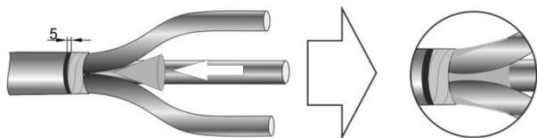
**1.7.** Жилы кабеля с усаженными трубками №3 плавно и постепенно выгнуть по шаблону. При отсутствии шаблона жилы можно изгибать вручную (через палец), не допуская крутых перегибов и повреждения изоляции. Удалить защитный пояс обложки, снять заусенцы,
