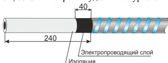
**2.3.** Со стороны торцов кабелей на половину длины гильзы удалить полиэтиленовую изоляцию с жил. Обернуть участок электропроводящего слоя пластиной для выравнивания напряжённости электрического поля с перекрытием 3-5мм, лишнее отрезать. Плотнo обжечь по всей плоскости, включая шов. Остатки воздуха под пластиной не допустимы.
