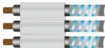
**3.2.** На каждый из одножильных кабелей надвинуть по одной манжете для изолирования контактного соединения.
