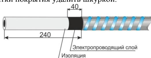
**2.3.** Со стороны торцов кабелей на половину длины гильзы удалить полиэтиленовую изоляцию с жил. Обернуть участок электропроводящего слоя пластиной для выравнивания напряжённости электрического поля с перекрытием 3-5мм, лишнее отрезать. Плотно обжать по всей плоскости, включая шов. Остатки воздуха под пластиной не допустимы.
