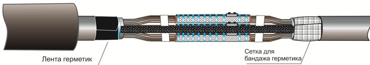
**22.**Надвинуть на муфту наружную термоусаживаемую трубу № 3, расположив ее симметрично относительно центра муфты. Удалить пленку рукавную. Усадить трубу пламенем газовой горелки, начиная с середины. После усадки по торцам трубы должен быть заметен выступивший расплавленный клей.
