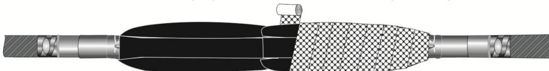
18. Обезжирить оболочки кабелей бензином или ацетоном. При низкой температуре прогреть. Надвинуть трубу №1 (полупрозрачную), расположив её по центру муфты. Для равномерного прогрева трубы, расплавления наполнителя и выхода остатков воздуха усадку производить от центра по окружности широким мягким пламенем. Через полупрозрачную стенку контролировать процесс расплавления наполнителя и отсутствие воздушных пузырей. После усадки по торцам трубы должен выступить клей.
